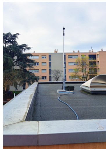
L'un des cinq micro-capteurs enregistrant en continu les niveaux sonores.
